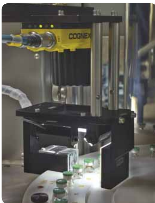
Dobře hlídáno: Inteligentní systém strojového vidění rozpoznává barvu a tvarování víček skleněných lahvíček.
