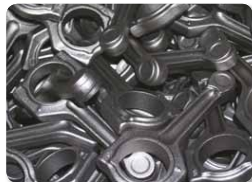
Opět sjednoceno a připraveno k zušlechťení: Ojnice po kontrole kvality.
