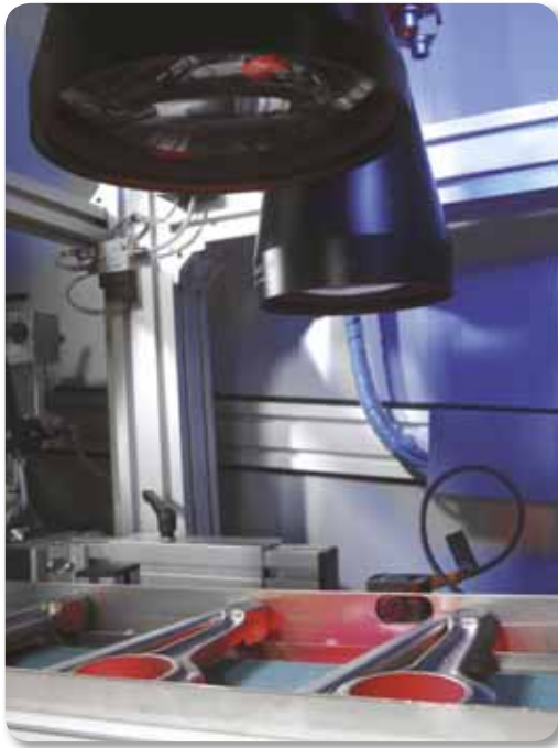
Rychle nejen u motorů pro osobní vozidla: Zařízení pro kontrolu ojníc v kovárně Schmiedetechnik Plettenberg kontroluje dílce v sekundovém taktu.
